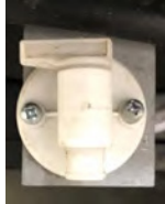
Exemple de drain extérieur d'eau douce
